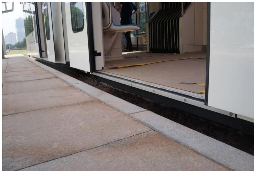
**“零碳交通工具”：超级电容、100%低地板车辆**
